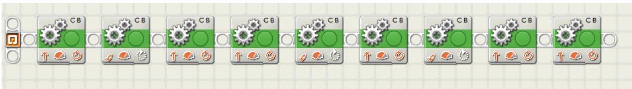
Известно, что робот едет вперед 1 оборот с мощностью 75, затем поворачивает налево на 90 градусов с мощностью 75. Далее, блоки имеют схожие параметры.
